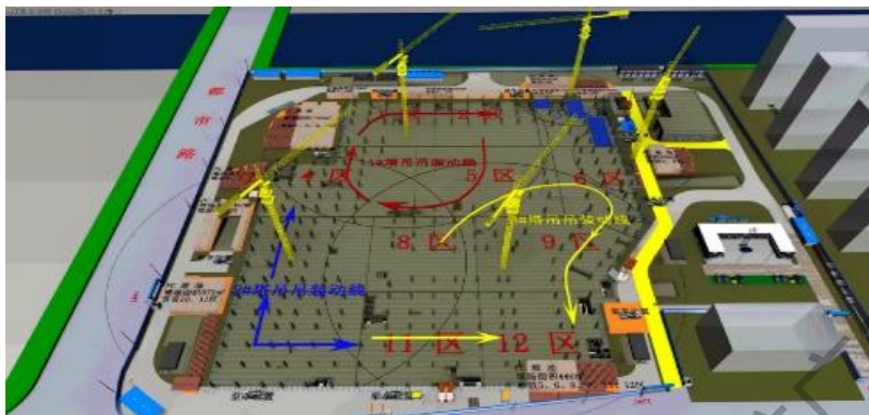
图 2-43 塔吊整体吊装动线
