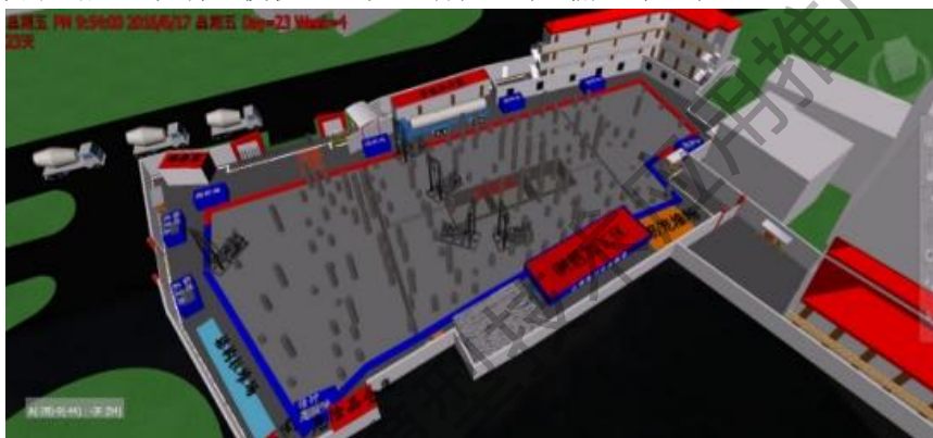
图 2-19 桩基施工 BIM-4D 模拟
