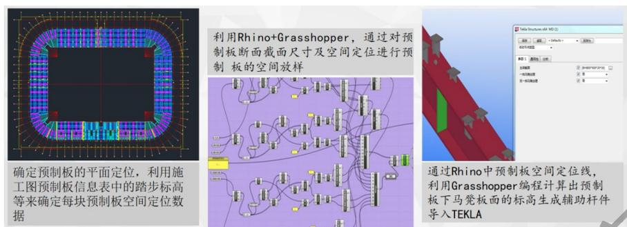
图 3-11 钢结构模型深化设计
