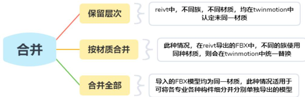
图 3-13 Twinmotion 模型导入分类
