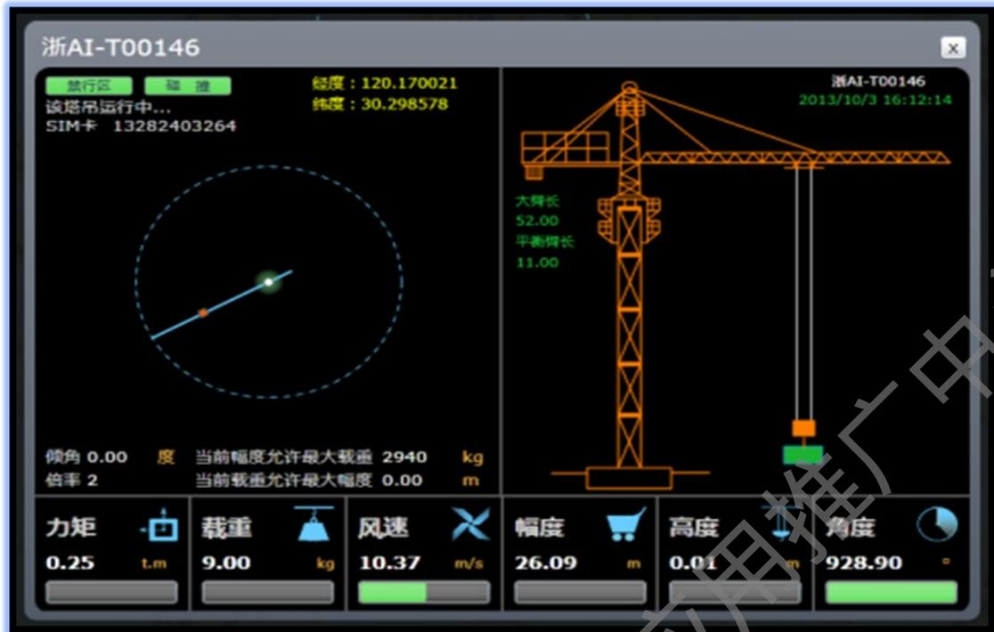
图 3-29 塔吊后台监控图
