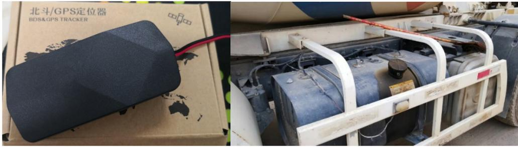
图 3-8 油耗监测与定位硬件模块
