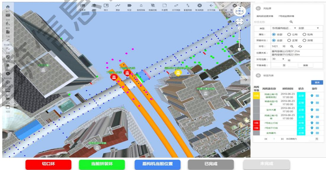
图 3-10 盾构掘进实时监测界面
