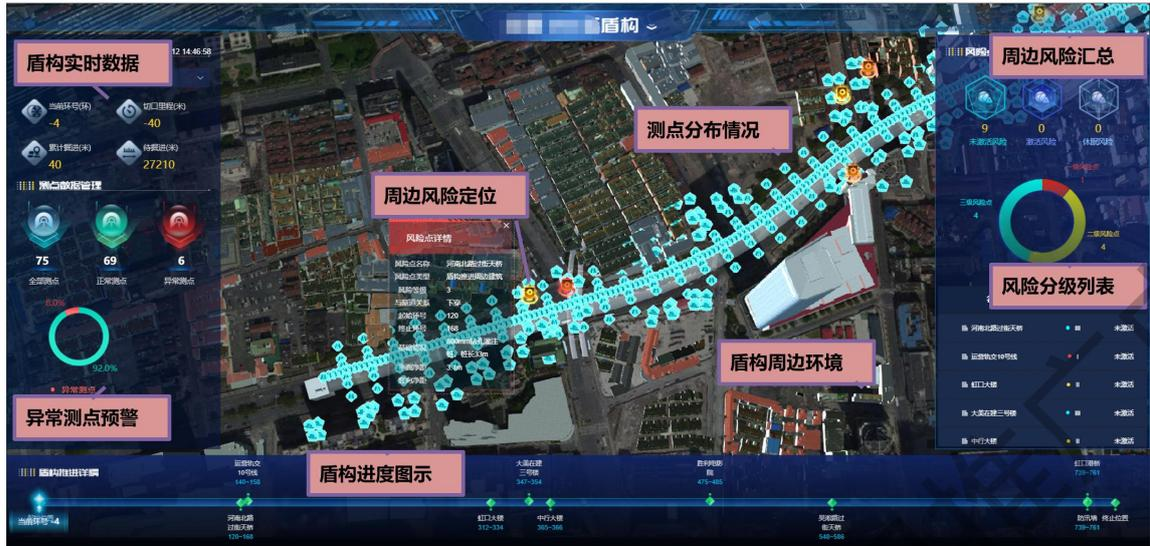
图 3-9 数字化盾构隧道监测平台界面
