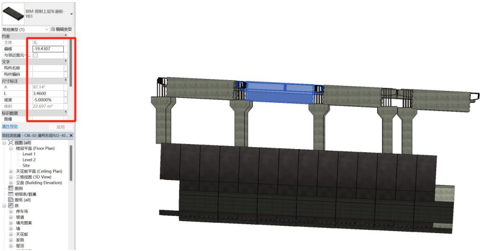
图 3-7 上层车道板搭接长度测算
