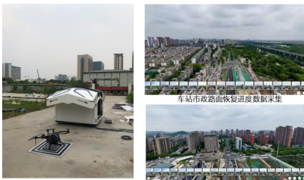
图 3-7 基于无人机技术的进度巡检
