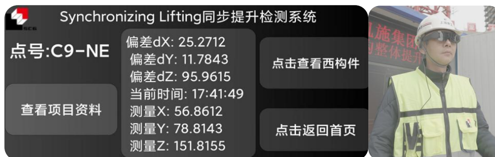
图 3-13 基于 AR 视觉的自动测量实时数据显示
