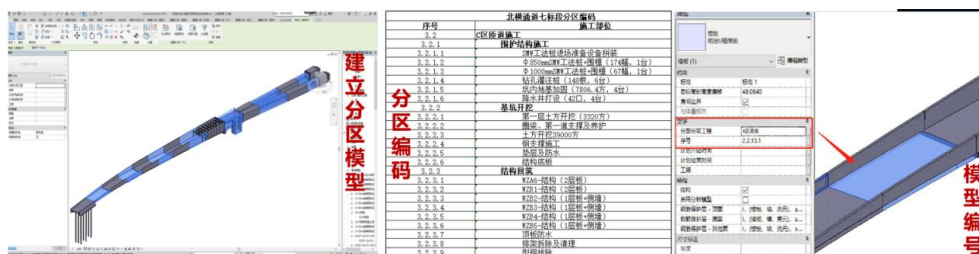
图 3-9 施工模型拆分及编码
