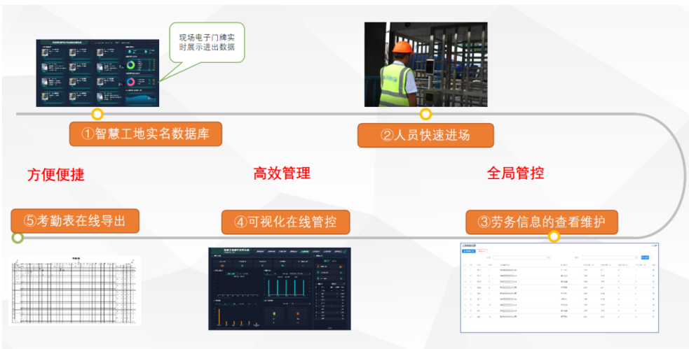
图 3-34 BIM 智慧工地平台—人员管控
