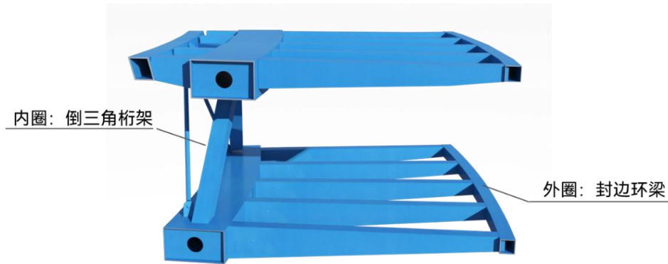
图 2-1 荣耀之环重心偏置开口的钢结构截面
