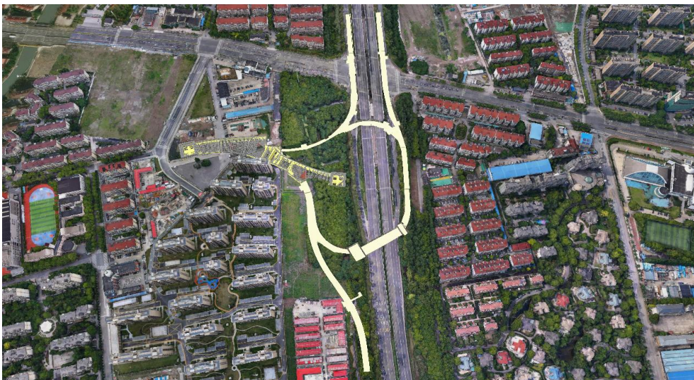
图 3-6 BIM+GIS+倾斜摄影数据融合
