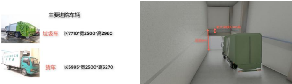
图 3-1 地下室车辆通行净高模拟
