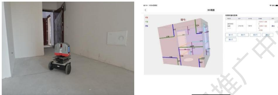
图 3-100 自行走实测实量机器人项目应用
